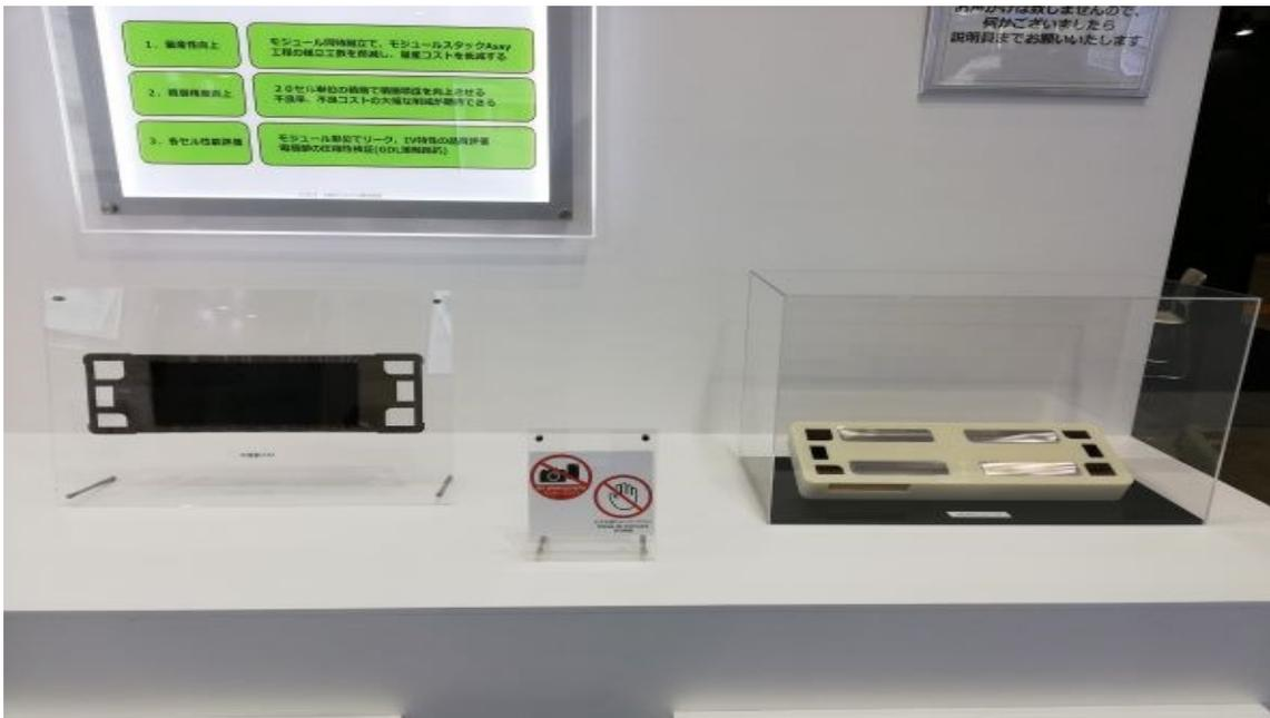
DARE ジャパンは高性能・高品質、低コストなスタックを開発するために、セルのモジュール化を進めております。モジュール化の特徴として以下 3 点がございます。1) 量産性向上 2) 積層精度向上 3) モジュール単位での各セル性能評価。モジュールを同時組立する事により、スタック組立工数の削減と量産コスト低減が可能となり、同時に積層精度も向上しました。今後も量産化実現に向けて開発を進めてまいります。
