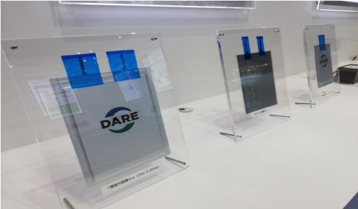
A5 尺寸電池的特征是容量相對較大(0.5Ah 以上)、可高電壓操作(對應 24V)的新技术。此外，通過串聯積層電極，我們的目標是實現內部電阻小，同時利用高安全性，在高電壓下操作的電池。現階段，我們與日本和世界各地的材料、設備和開發支持服務公司密切合作，開發全固態電池。展望未來，我們將根據市場趨勢，在考慮汽車應用的同時，為無人機和服務機器人等廣泛領域進行開發。
