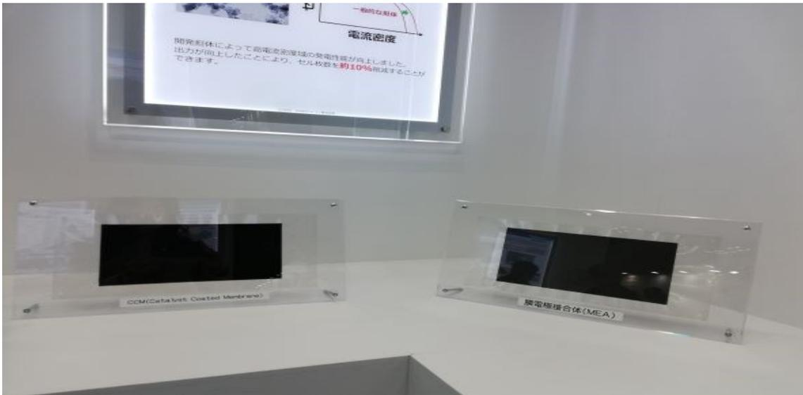
DARE 日本的燃料电池触媒载体的特征是通过使用高阶结构的发达载体，可以提高触媒层的气体扩散性、排水性。其结果，高电流密度范围的发电性能和功率得到了提升，电池片数也减少了约 10%。
