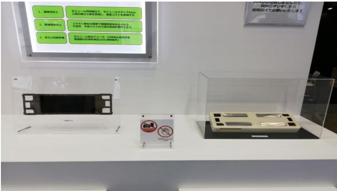
DARE 日本为了开发高性能・高品质、低成本的电堆，正在对电池进行模块化。模块化的特征有以下 3 点。1) 提高量产性 2) 提高积层精度 3) 以模块单位评估各电池性能。通过同时组装模块，可以减少电堆组装的时间和减少量产成本，同时可以提高积层精度。我们将继续开发，以实现量产。
